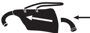
2. Inserte el tubo en la salida de aire del motor hasta el fondo.
