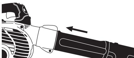
4. Transformar no slot até que ele pára a âncora. Após este procedimento, eles devem apertar o parafuso (A), para proteger a União entre o tubo de sopro.
