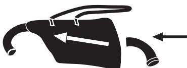
2. Introduza o tubo na saída de ar do motor na parte inferior.
