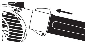
3. Transformar no slot até que ele pára a âncora. Após este procedimento, eles devem apertar o parafuso (A), para proteger a União entre o tubo de sopro.
