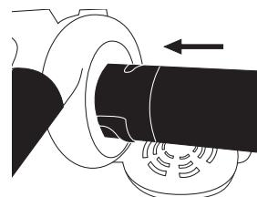
Nota: Esta máquina tem um interruptor de segurança que impede o arranque de máquina com tampa do ventilador aberta e sem instalar os tubos de aspiração. Verifique o interruptor de segurança está conectado firmemente para o alojamento do ventilador que envolve uma vez instalado aspiração do tubo, caso contrário que a máquina não irá iniciar.
