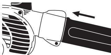
3. Vissez dans le sens des rainures jusqu'au fond. Une fois finie, serrez les vis (A) pour fixer le tuyau de soufflage.
