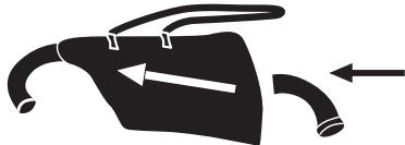
2. Connecter le tuyau du sac à la sortie de l'air.
