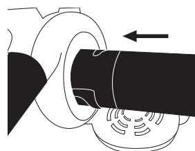
Nota: Esta máquina dispone de un interruptor de seguridad que evita que la máquina arranque con la cubierta del ventilador abierta y sin instalar los tubos de aspiración. Compruebe que el interruptor de seguridad está bien sujeto a la carcasa del ventilador para que se active una vez se instala el tubo de aspiración, de lo contrario la máquina no arrancará.
