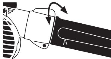
4. Abra a tampa do ventilador girando a asa.
