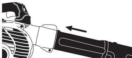
4. Gire siguiendo la ranura hasta que el anclaje llegue a su tope. Una vez terminado este procedimiento, se debe apretar el tornillo (A), para así fijar la unión del tubo de soplado.
