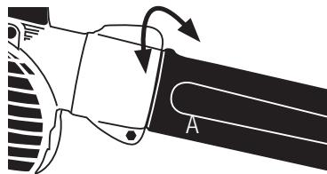
4. Abrir la cubierta del ventilador girando la palomilla.
