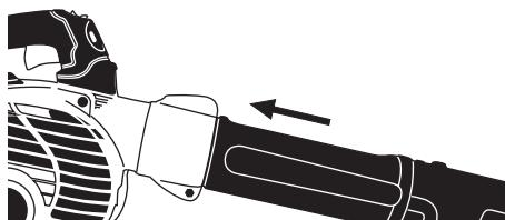
4. Vissez dans le sens des rainures jusqu'au fond. Une fois finie, serrez les vis (A) pour fixer le tuyau de soufflage.
