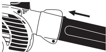
3. Gire siguiendo la ranura hasta que el anclaje llegue a su tope. Una vez terminado este procedimiento, se debe apretar el tornillo (A), para así fijar la unión del tubo del saco.
